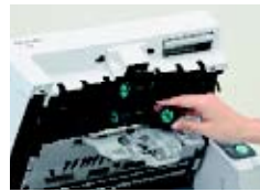
Rollen können leicht ausgetauscht werden. Der Scanner ist weit zu öffnen.
